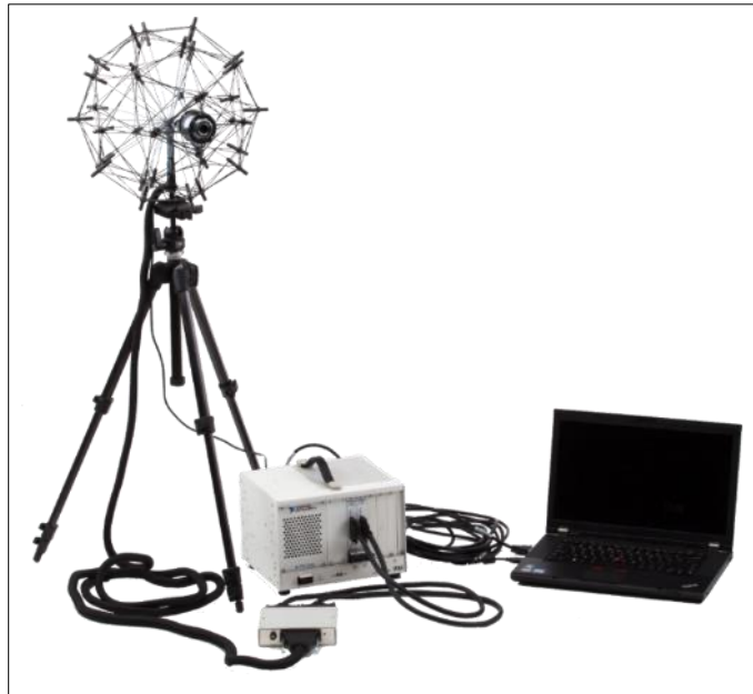
Figura 8: Sistema de medición con cámara acústica, interfaz y computador 15 .
