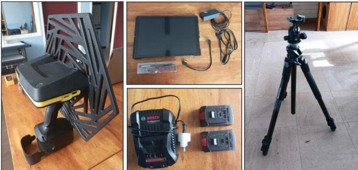
Figura A3: Elementos que configuran la cámara acústica Mikado de gfai tech.
