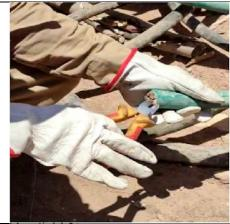
Cortar cubierta de cable: Una vez que realiza el corte guía, utiliza el alicate cortante, apoyándolo entre la base del pulgar y el resto de los dedos. Se observa compresión sobre la base del pulgar y flexoextensión de dedos.
