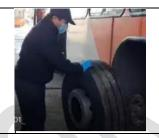
Volviendo a montar el neumático una vez terminado el cambio de pastillas de freno.
