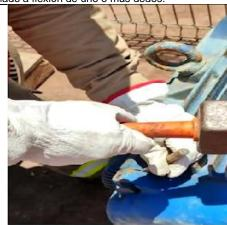
Apertura de motor: Después de soltar todos los pernos, el trabajador separa las partes, utilizando un punzón con la mano izquierda y un combo con la derecha. Según el estado del motor es la fuerza que deberá aplicar para la apertura. Se observa compresión sobre la base del pulgar en el agarre del combo.
