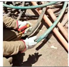
Apertura de cable. Una vez que corta la cubierta del cable, el trabajador separa la cubierta, exponiendo el cableado interno. Esta operación fue simulada para efectos de esta EPT. No se observa factor de riesgo postural en esta operación.
