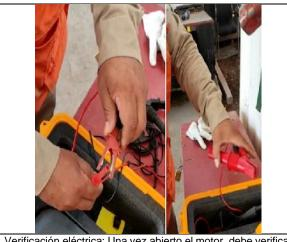
Verificación eléctrica: Una vez abierto el motor, debe verificar el paso de corriente, para lo cual utiliza unas pinzas conductoras en los 12 circuitos presentes por motor. Habitualmente lo realiza con la mano derecha; en la demostración se observa el uso de mano izquierda, lo que se debe a dolor por enfermedad de la mano dominante. Se observa flexión y extensión de los dedos.
