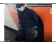
Desmontando el neumático en forma manual, la cual tiene un peso aproximado de 30 kg.
