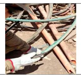
Cortar cubierta de cable: El trabajador utiliza un cuchillo cartonero para guiar el corte y un alicate de corte, para lo definitivo. Se observa flexión de dedos asociado a fuerza.
